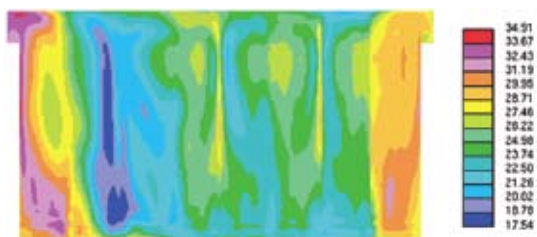
Рис. 6. Поле температуры в продольном разрезе МЦОД «Датериум 1»
